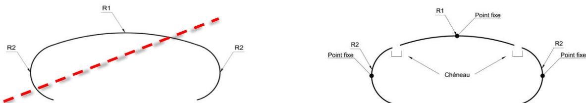
Le fait de mettre un unique point fixe au faîtage ne permet pas de respecter la condition d'accroissement des rayons en s'éloignant du point fixe (puisque R1 > R2).
