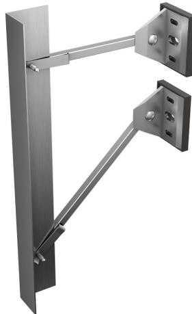
Je nach Ausführung gibt es zwei Festpunkttypen: Typ 1 kann bis ca. 20 kg/m<sup>2</sup> Fassadengewicht eingesetzt werden. Der Festpunkt Typ 2 kann auch für massive und schwere Fassaden, wie zum Beispiel Stein- oder Keramikfassaden, eingesetzt werden.
