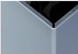
Auf der Rückseite werden mit Scheiben- oder Formfräsern V-förmige Nuten eingefräst. Dabei bleiben das Aluminium-Deckblech der Vorderseite und 0,3 mm des Kernmaterials stehen. Die geringe Dicke des verbleibenden Materials ermöglicht dann ein Abkanten „von Hand“. Eine Kantbank ist nicht erforderlich. Die Nutform bestimmt den Biegeradius.
